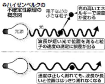
電子など小さな粒子の位置と速度を同時に正しく測定することは不可能とする「ハイゼンベルクの不確定性原理」が、昔には成り立たないという実験結果が、ウィーン工大と名古屋大の研究チームがまとめた。80年以上前に提唱された量子物理学の基本原則を崩す成果で、ナノ科学での新たな測定技術開発の手がかりになるという。15日付の科学誌ネイチャー・フィジックス電子版に掲載される。物が見えるのは、物に照
