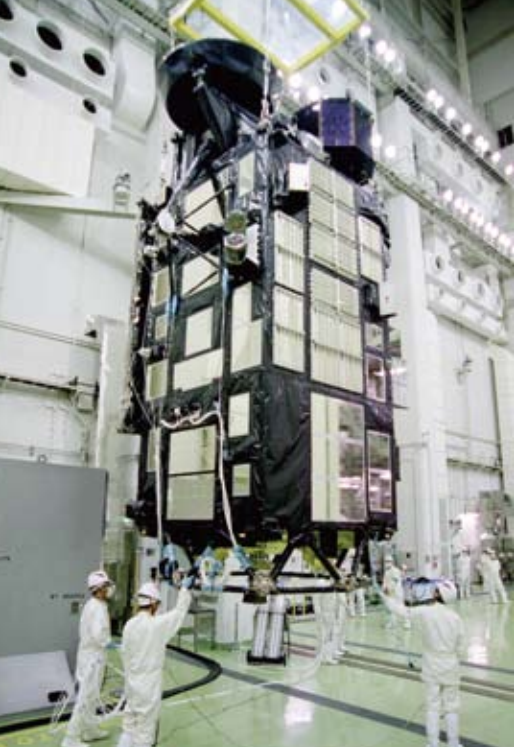
月探査機「かぐや」 左は整備中の風景。底部に推進エンジンがある。上部の手前に見えるのはハイゲインアンテナ（右ページのイラスト参照）。上部の奥手に子衛星が見える。上の写真は、かぐやが月に落下したときの管制室の模様。関係者の間からは自然に拍手がわき上がった。
