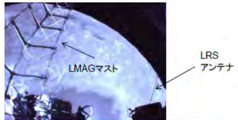
月磁場観測装置 (LMAG) マスト及び月レーダサウンダー (LRS) アンテナの進展後の様子 78
